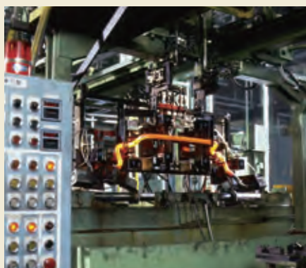
当社が開発した「中空スタビライザ」の熱処理工程
