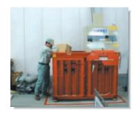
排出物の中で軟質プラス チックとダンボールは、かさ ばるため取り扱いが困難 でした。この改善に減容機 を導入し、保管スペースの 確保や収集運搬の効率ア ップを図っています。
