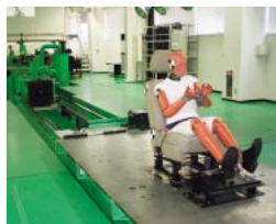
新設された油圧式スレッド試験機
