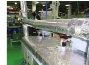
加熱炉の保温性を高める炉断熱カバー(タイニッパツ)
