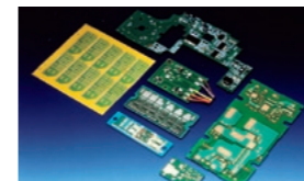
金属ベースプリント配線板
