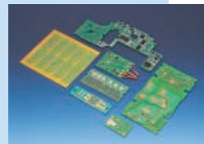
金属ベースプリント配線板
