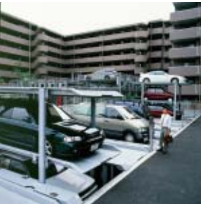
立体駐車装置
